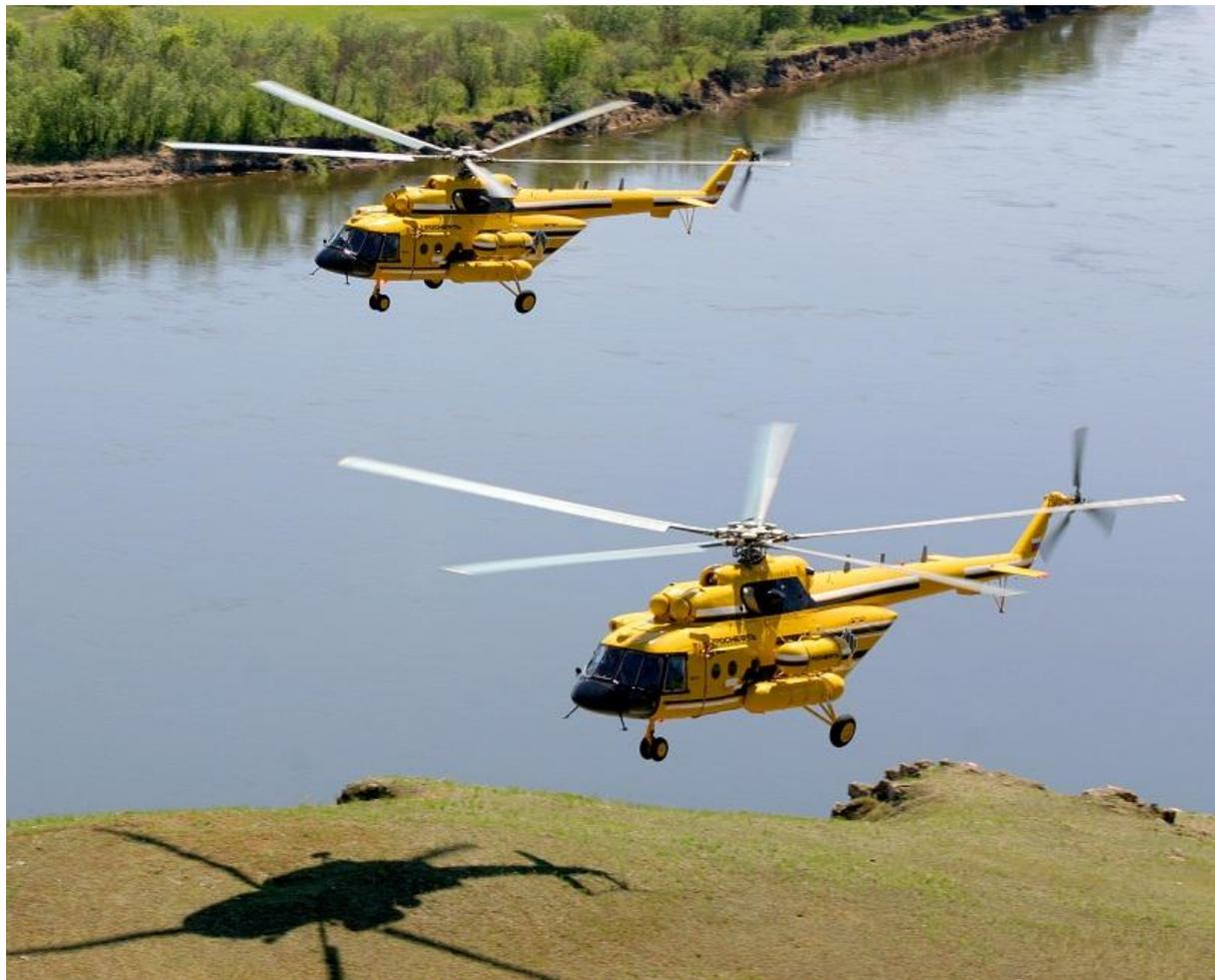
На Ми-8АМТ НК «Роснефть» установлены система раннего предупреждения близости земли и система предупреждения столкновения с воздушными судами в воздухе МСНВО-2010. Установленная на вертолетах вспомогательная силовая установка ТА-14 обеспечивает большую высотность запуска двигателей, увеличенную мощность и время работы в генераторном режиме.
