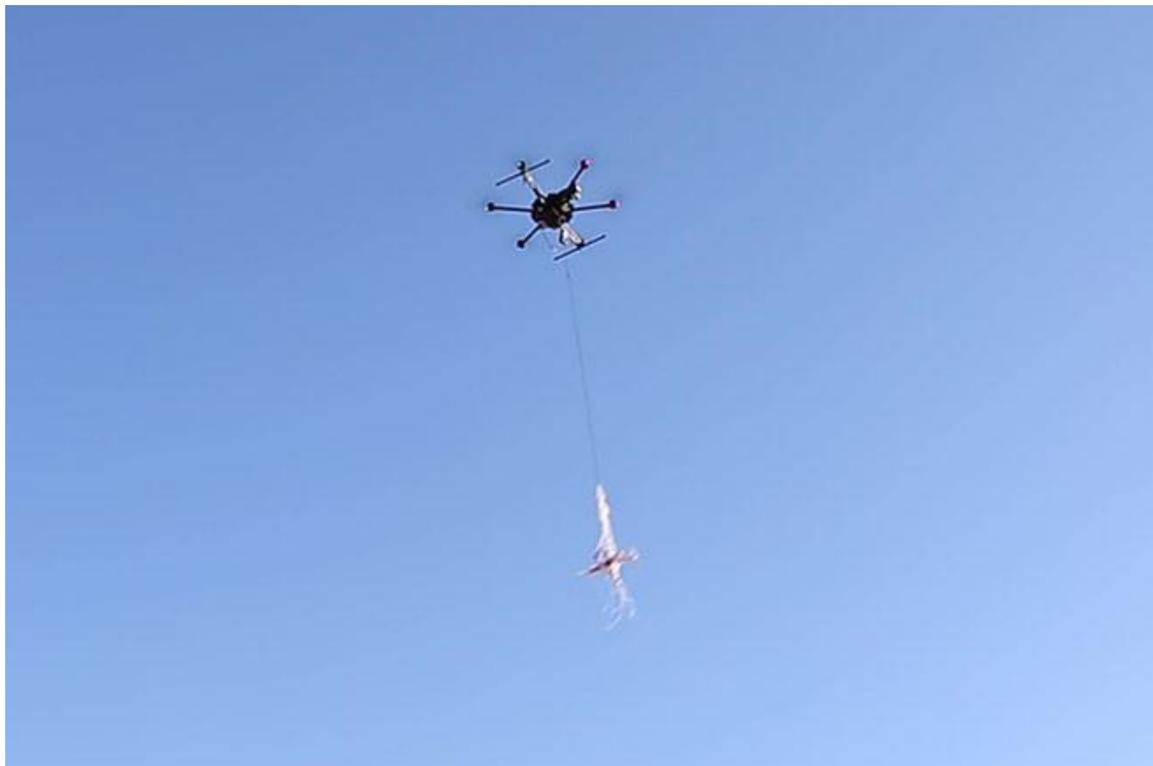
Компания Airspace Systems разработала беспилотный летательный аппарат, который поможет в поимке дронов, залетевших в "запрещённое" воздушное пространство. Для этого он использует кевларовую сеть на тросе, которой просто опутывает беспилотник-нарушитель и относит на пост охраны, сообщает [dailydot.com](http://dailydot.com).
