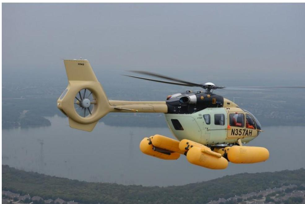
Обновление спасательного комплекса отличается улучшенной доступностью к спасательным плотам, закреплённым на корпусе вертолета, и их более оперативное развертывание. Также новая система экстренного приводнения H145 дает вертолету повышенную стабильность на поверхности воды благодаря конструкции с трехпозиционным поплавком, имеет сниженный вес, а также лучшую совместимость с другим дополнительным оборудованием вертолета, таким как лебедки.
