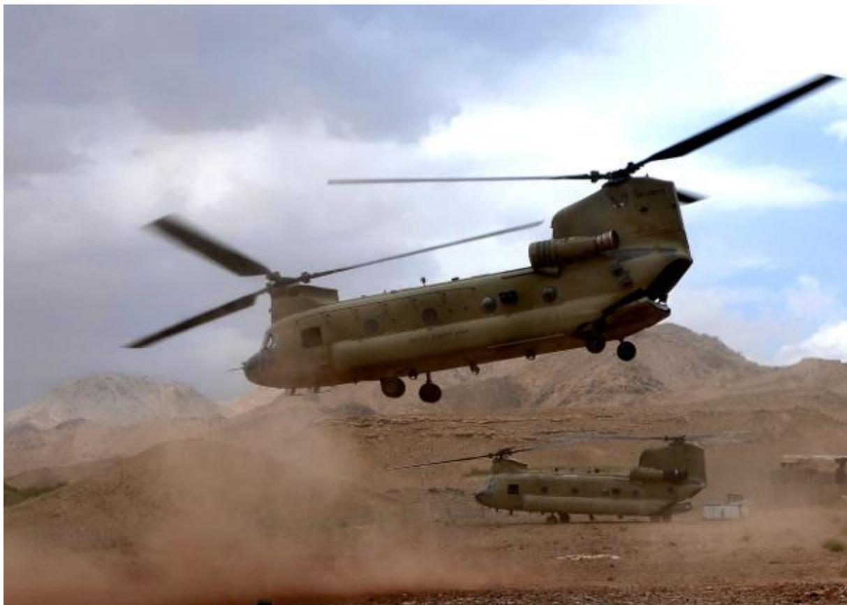
Вертолеты Chinook используются американскими военными с 1962 года. За это время они прошли несколько программ модернизации. Последняя версия вертолета - CH-47F - поставляется в войска с 2008 года. Машина, выполненная по продольной схеме расположения винтов, имеет в длину 30,1 метра с учетом роторов диаметром 18,3 метра каждый.
