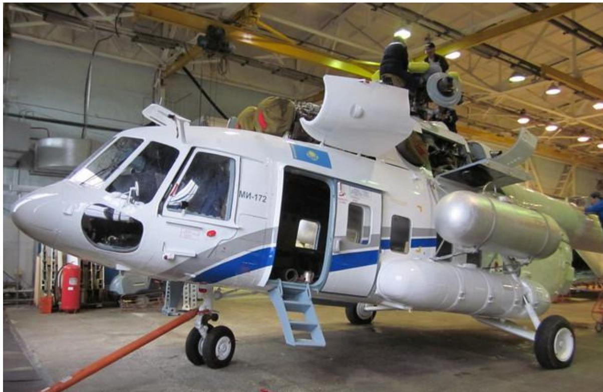
Капитальный ремонт затронул все системы и агрегаты машины. Совместно с ведущими партнерами предприятие выполнило такие задачи, как замена двери-трапа на сдвижную дверь, а также капитальный ремонт основной и вспомогательной силовых установок и главного редуктора.
