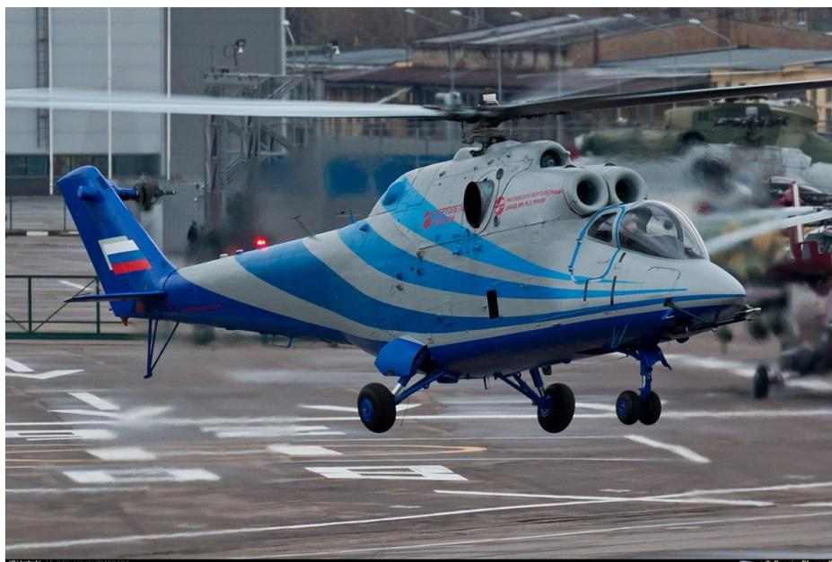
Конструкция ЛЛ ПСВ значительно отличается от Ми-24. Некоторые элементы фюзеляжа летающей лаборатории доработаны, что значительно снижает сопротивление воздуха и улучшает аэродинамику вертолета на больших скоростях полета.
