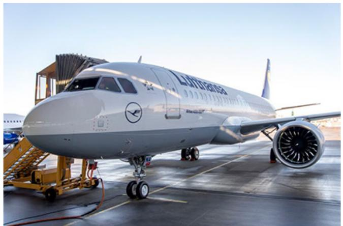
Вместимость A320neo составляет 180 мест для пассажиров в бизнес- и экономическом классах. Благодаря улучшениям аэродинамических характеристик и новому двигателю PW1100G производства Pratt & Whitney новый самолет будет расходовать на 15 процентов меньше топлива, чем предыдущая модель, отметили в Airbus.
