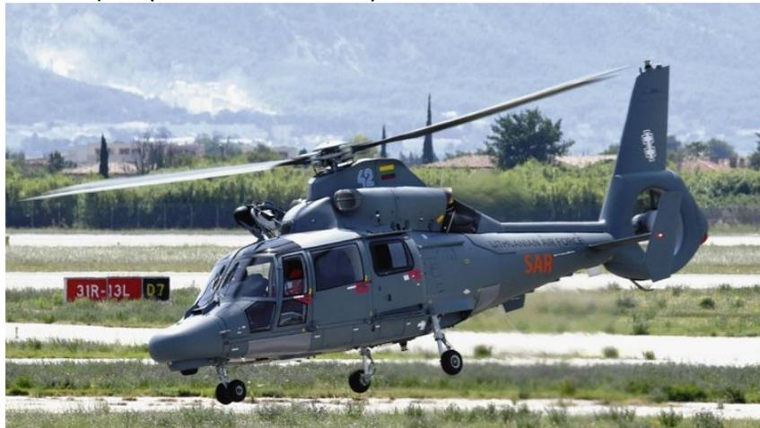
Как отмечает «Эйрбас», вертолеты оснащены «стеклянной кабиной», 4-осевым автопилотом, ИК-станцией и радаром. С введением новых машин литовские вооруженные силы смогут вывести из своего состава стареющие вертолеты Ми-8/17.
