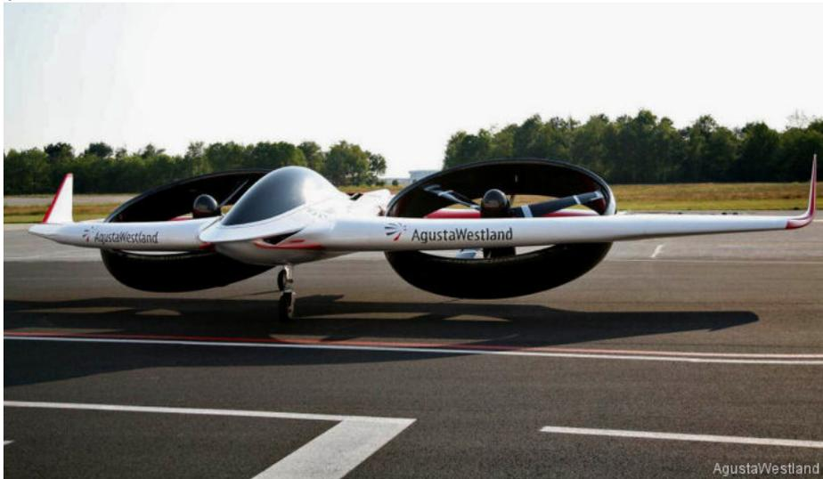
Во время крейсерского полета крылья аппарата обеспечивают большую часть подъемной силы, свой вклад также вносят спрофилированные фюзеляж и кожухи винтов. В этом проекте также предусмотрена отстыковка консолей крыльев и работа аппарата только в вертолетном режиме. Элевоны на крыльях позволяют управлять воздушным судном в крейсерском полете по тангажу и крену, в то время как V-образный хвост обеспечивает продольную устойчивость.
