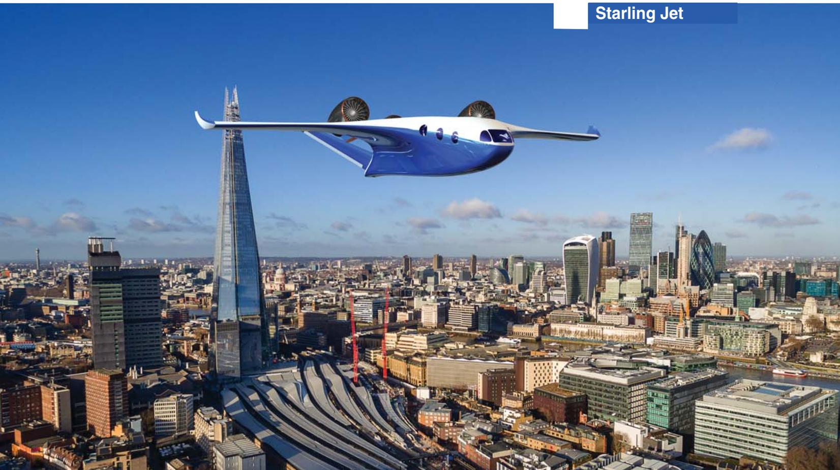
С электрическими аппаратами конкурируют гибридные. Чего стоит, например, амбициозный проект бизнес-джета под названием Starling Jet, разрабатываемый британской Samad Aerospace. На вертикальных посадках, взлётах и небольших дистанциях будут использоваться 5 электроприводов. Для длительных перелетов предусмотрен турбовентиляторный двигатель. С полной загрузкой и 10 пассажирами на борту аппарат сможет преодолеть до 2400 км на скорости 700 км/ч. Летный образец должен появиться к 2024 году.
