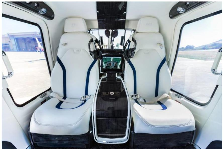
В интерьере MAG для Bell 505 добавлены новые панели/облицовки на потолке, дверях и стенах, модифицированные кресла пассажиров и экипажа, ковровое покрытие и пороги для входа. Это добавляет всего 70 фунтов к весу вертолета.
