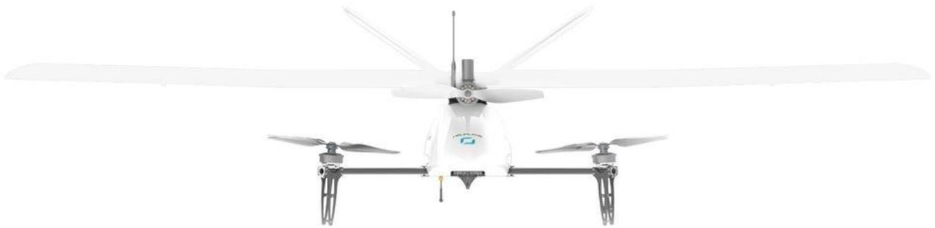
Drone Volt - достаточно крупный беспилотник, доступный в двух размерах: с размахом крыла 230 и 280 см. Первая версия аппарата имела только пропеллеры, которые позволяли ему совершать вертикальный взлет и посадку, а при подъеме на достаточную высоту переходить в горизонтальный режим полета.
