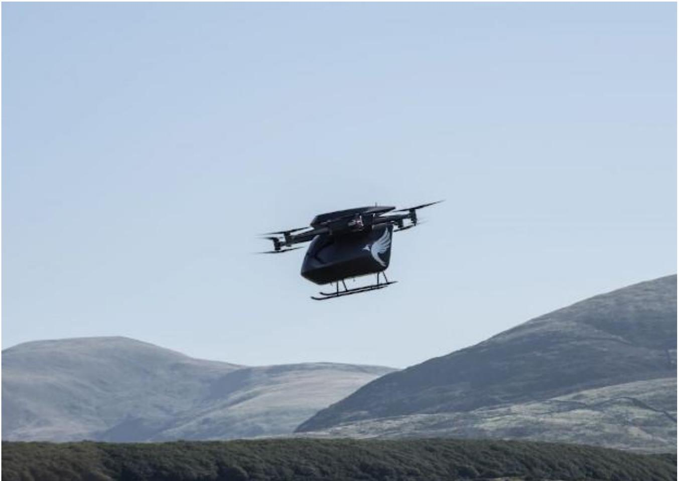
Большинство электрических аэротакси, сегодня проходящих испытания в мире, рассчитаны на перевозку одного или двух пассажиров и небольших грузов. Общая масса пассажиров и грузов у таких аппаратов не превышает 200 килограммов. Например, немецкое аэротакси Volocopter 2X способно нести нагрузку массой до 160 килограммов.
