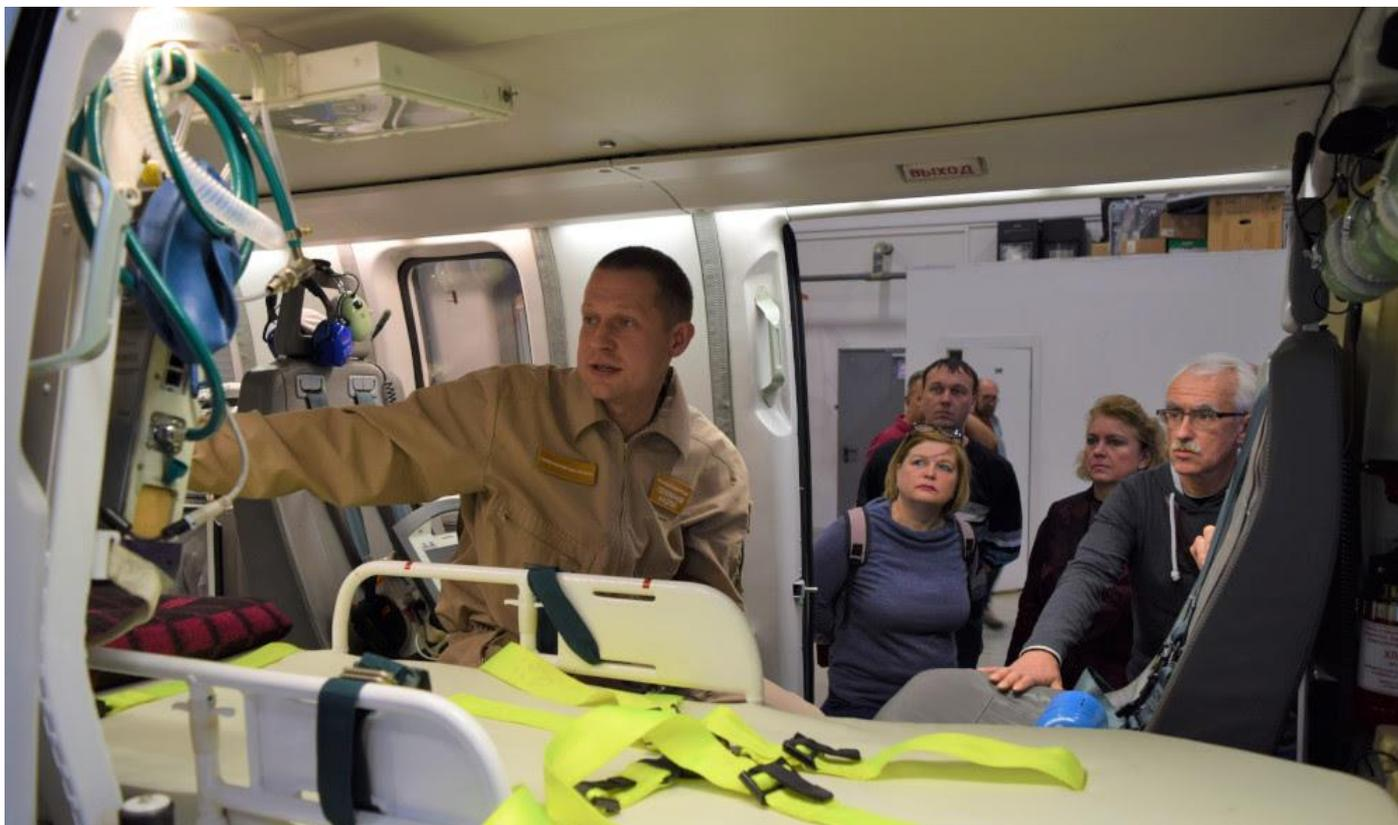
Медицинский модуль вертолета «Ансат» производится ООО «Казанский агрегатный завод» и применяется для эвакуаций носилочных пациентов «крайне тяжелой» и «тяжелой» степени тяжести, непрерывного мониторинга состояния пострадавшего, поддержания жизненно важных функций организма и проведения медицинской бригадой во время эвакуации интенсивной терапии в объеме специализированной врачебной помощи, а также обеспечивает возможность ухода за эвакуируемым пострадавшим.
