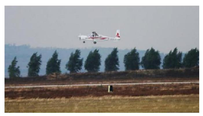
Самолет длиной 8,4 м был разработан Ляонинской академией авиации общего назначения (ЛААОН). Дальность полета составляет 300 км, самолет способен пролететь без подзарядки около полутора часов. Эти характеристики будут улучшаться по мере совершенствования технологий по производству батарей.
