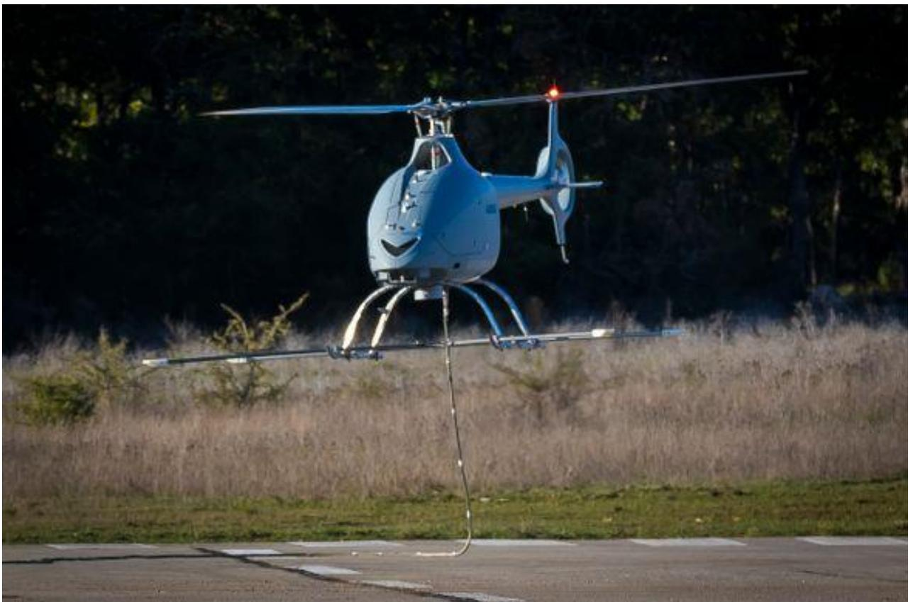
В соответствии с требованием регулятора, предоставившего разрешение на полеты, полет VSR700 проходил с использованием 30-метровых тросов для обеспечения полной безопасности в зоне летных испытаний. Последующие этапы испытательной программы предусматривают свободный полет, а затем и постепенное расширение области полетных режимов.
