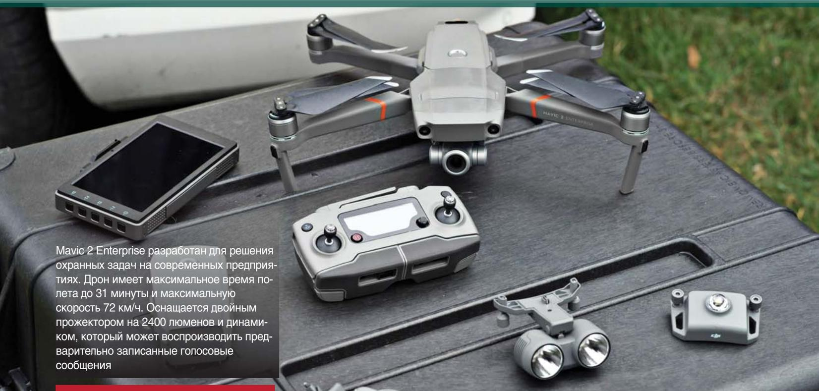
Mavic 2 Enterprise разработан для решения охранных задач на современных предприятиях. Дрон имеет максимальное время полета до 31 минуты и максимальную скорость 72 км/ч. Оснащается двойным прожектором на 2400 люменов и динамиком, который может воспроизводить предварительно записанные голосовые сообщения
