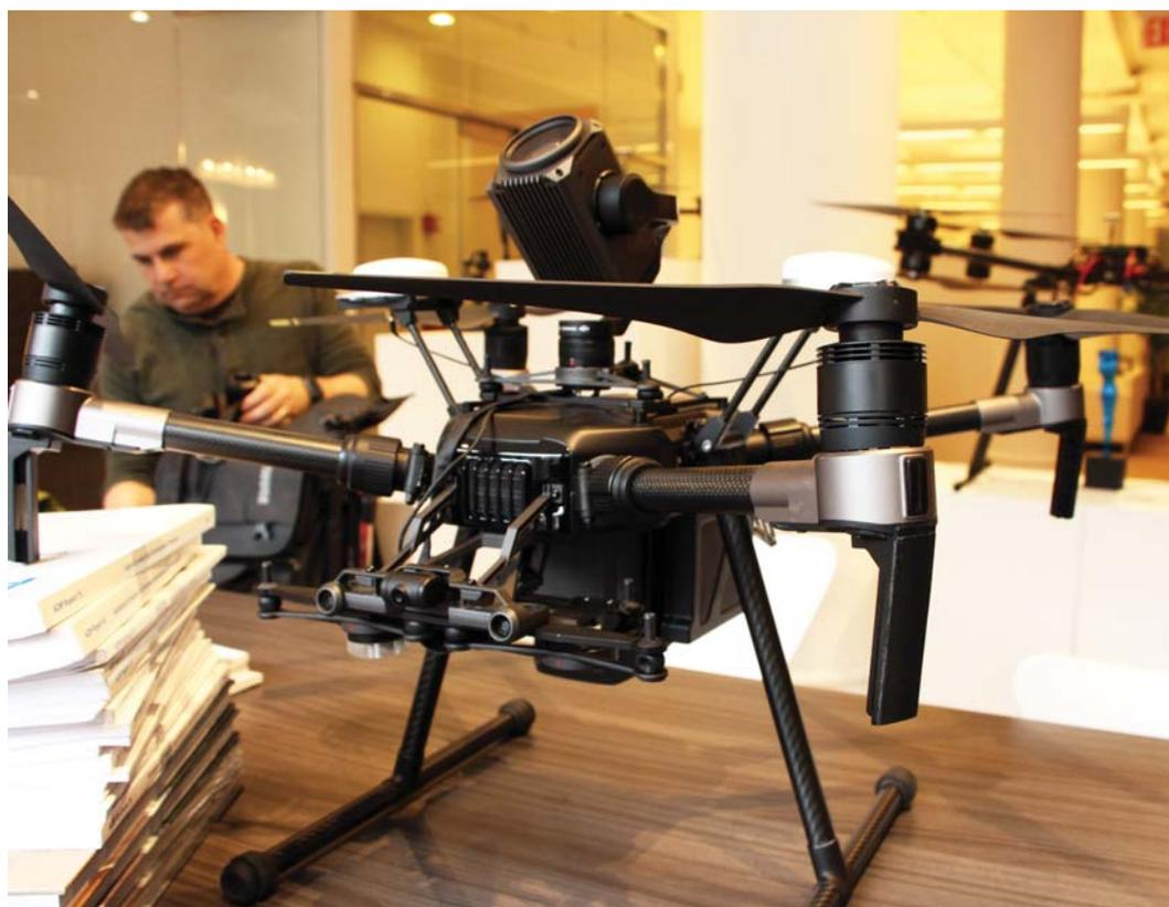
Matrice 200 с 30-кратным оптическим зумом Zenmuse Z30 и тепловизором XT
