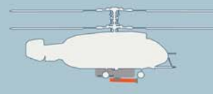
Система горизонтального, вертикального и бокового пожаротушения. Предназначена для тушения пожаров, в том числе в высотных зданиях
