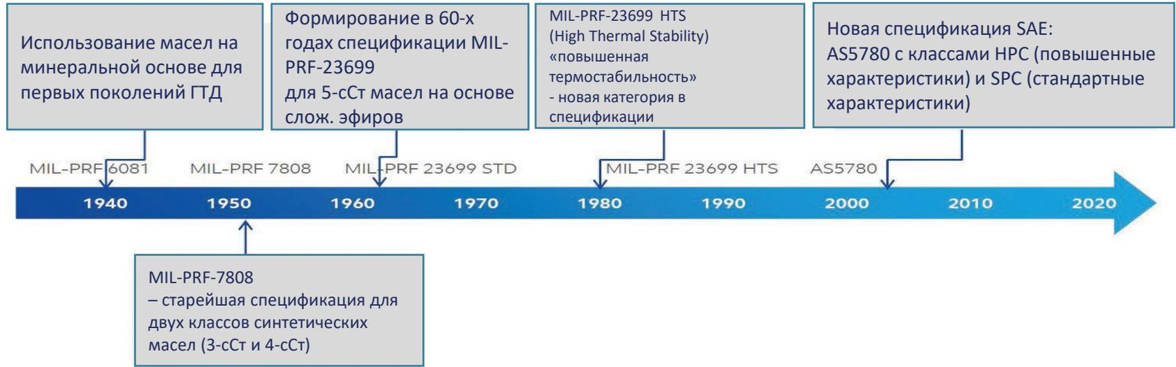
Рост теплонапряженности авиационных ГТД значительно повышает требования к уровню термостойкости / термостабильности масел:
