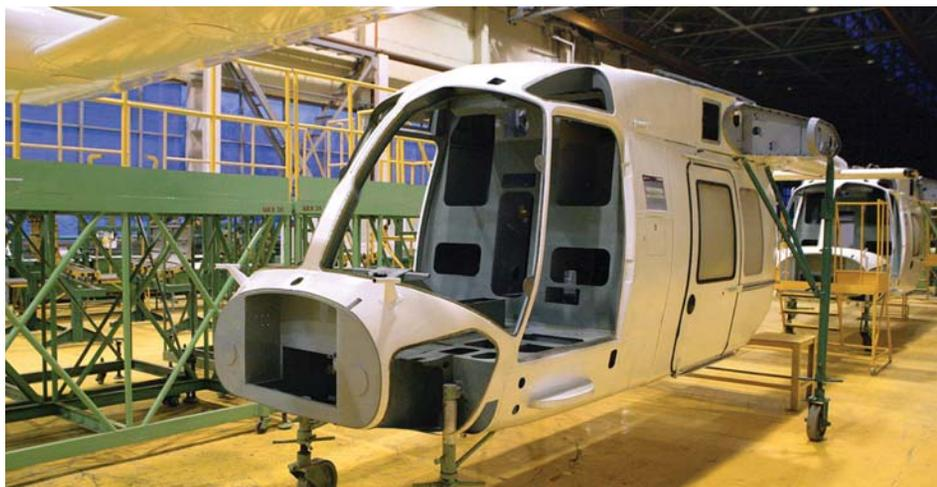
Фюзеляж изготавливаемого на АО «У-УАЗ» опытного образца Ка-226Т для Индии
