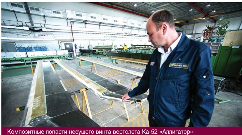
Композитные лопасти несущего винта вертолета Ка-52 «Аллигатор»
