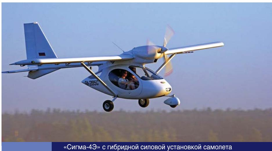
«Сигма-4Э» с гибридной силовой установкой самолета
