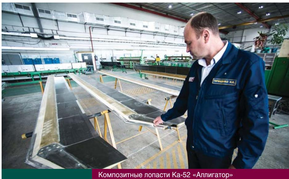
Композитные лопасти Ка-52 «Аллигатор»
