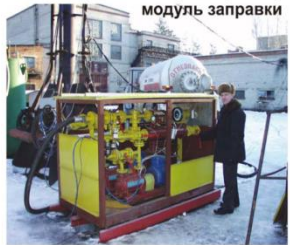
Универсальный (газ-керосин) модуль заправки
